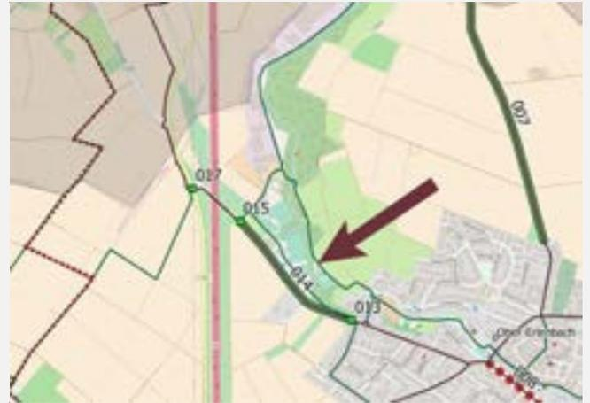
Ist-Zustand: Es existiert kein straßenbegleitender Geh- und Radweg. Die zulässige Höchstgeschwindigkeit liegt bei 70 km/h. Die derzeit geführte Radverkehrsverbindung verläuft auf einem Gehweg durch die Sportanlage und stellt einen Nutzungskonflikt mit Fußgängern dar. Die Verbindung ist umwegig und birgt durch die zweifache Querung der Seulberger Straße ein erhöhtes Unfallrisiko.
