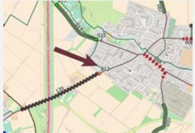
Ist-Zustand: Fehlende Überführung von einseitigem Zweirichtungsweg ortseinwärts auf die Fahrbahn. Der Weg ist nicht für Radfahrer freigegeben. Verengung des Weges durch Stromkasten und FSA-Mast in Zufahrt Kreuzung.
