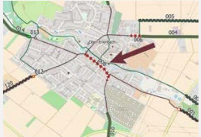
Ist-Zustand: Fehlende Radverkehrsanlagen. Radfahrer müssen auf der Fahrbahn fahren. Die Fahrbahnbreite beträgt teilweise lediglich 6 Meter.
